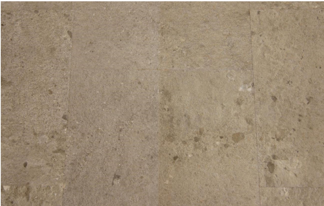
Figure 4 : après 25 fois le nettoyage humide avec une solution teintée de PU Cleaner ; à gauche PU Anticolor satin, à droite non scellé
